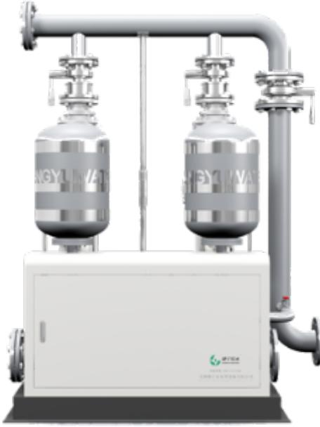
智能恒压供水设备具有性能的PID变频控制和两台或多台泵并联组成的前列加压供水设备，可以自动调节以满足用户对智能恒压供水的要求。供水管网的压力保持恒定，整个供水系统始终保持比较好节能状态。有两种供水方式：变频供水和压力供水。变频供水是一种理想的供水方式，它可以自动调节一台泵的转速，使几台泵投入/停止运行，这样供水管网的压力可以保持恒定，操作简单。根据管网用水量和水压的变化，设备可以在管网计算机检测、计算和反馈过程中通过无级调速保持水压恒定，以满足用水量的要求。与传统的水塔、高位水箱和气压供水设备相比，该系统在水质、建设成本、运行经济性、可靠性和智能性等方面具有优势。近年来，它已广泛应用于建筑的各种二次供水系统、喷灌和工农业生产的增压设备中。变频水箱 无负压供水 变频供水生产厂家。盐城无负压叠压无负压制造商
